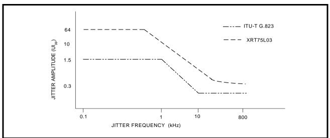
FIGURE 23. INPUT JITTER TOLERANCE FOR E3
