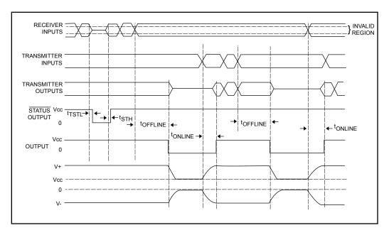
Auto On-Line® Plus Timing Diagram tstl (=30µs typ.) tsth (=0.4µs typ.) toffline (=30s typ.) tonline (=100µs typ.)
